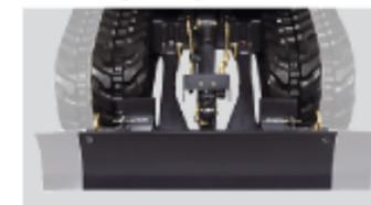
Par le simple manement d'un axe, la largeur de la lame peut-être modifiée rapidement.
